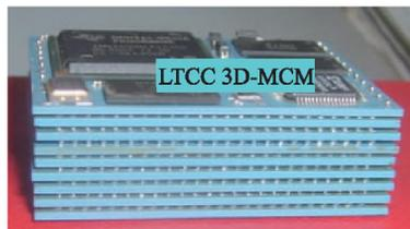
图15 多层隔板LTCC 3D-MCM
