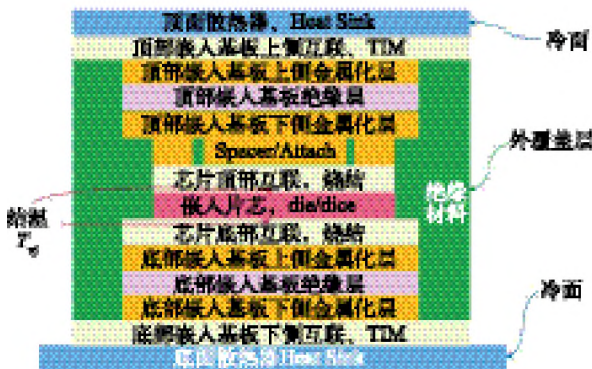
图 8 嵌入式基板、双面空冷散热的剖面构造 [42]
