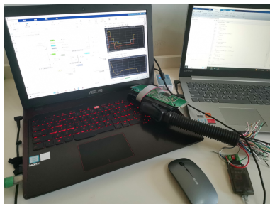
图7 硬件在环实验平台
