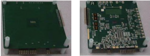
(a) 正面 (b) 背面 图1 60 GHz 相控阵天线
